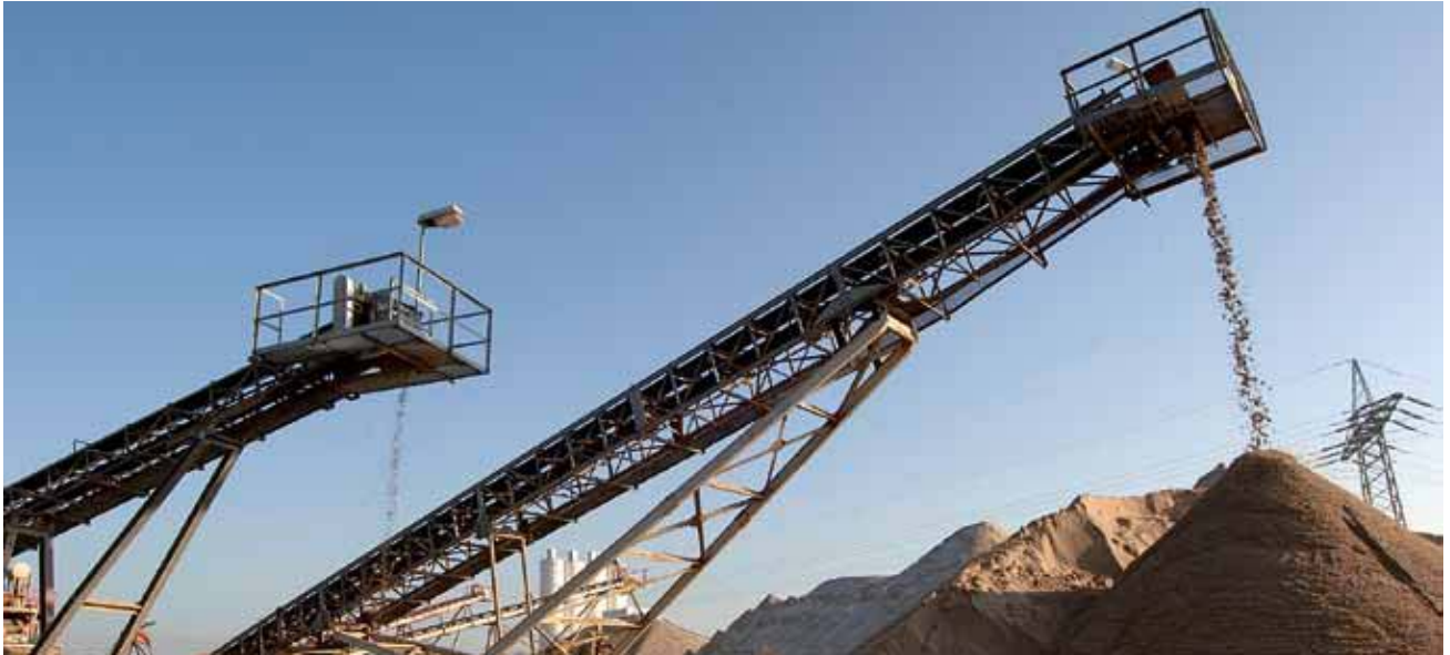
Die Kies- und Sandindustrie am Niederrhein hat Tradition – Sortierbänder und Sandhügel unterschiedlicher Körnung.
