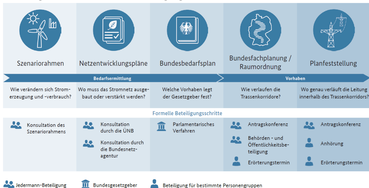
Abbildung 3: Überblick Verfahren Übertragungsnetzausbau
